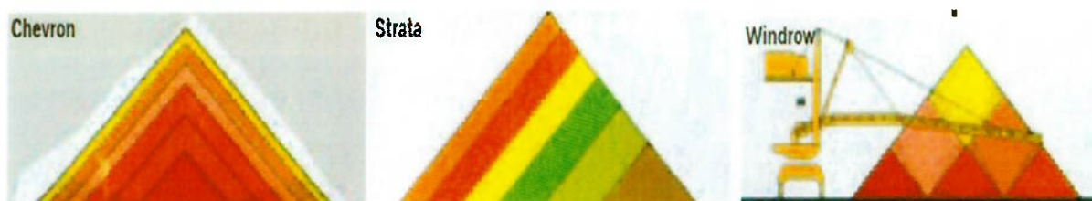
Figura 1 - Os três métodos de empilhamento que serão tratados neste trabalho: Chevron, Strata e Windrow.
