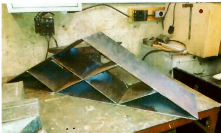
Figura 25 - Dispositivo de corte e amostragem de material para estudo da pilha.
