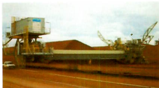
Figura 15- Retomador de Ponte com roda de caçambas.
