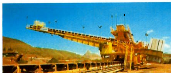
Figura 9 - Empilhadeira com lança fixa e única instalada em Mina de Vargem Grande.
