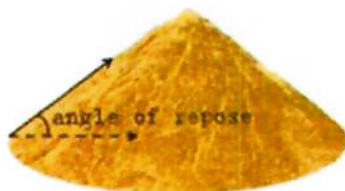
Figura 21 - Ilustração do ângulo de repouso de um material.
