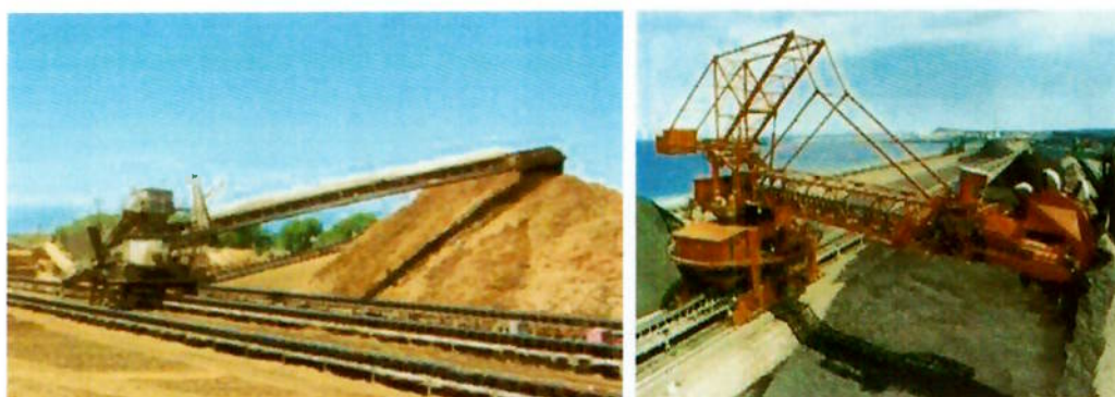
Figura 2 - Stacker e Reclaimer (da esquerda para a direita).
