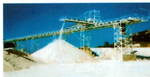
Figura 13 - Transportador de Correia acoplado a Tripper.
