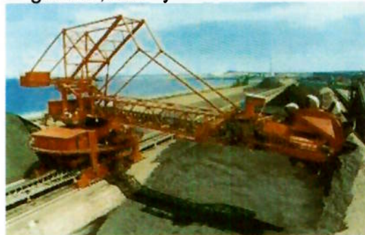
Figura 16 -Retomador de lança com roda de caçamba.
