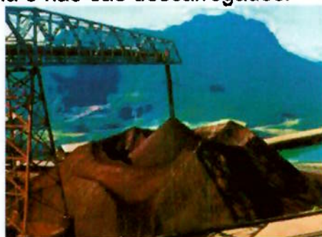
Figura 40 - Retomada por baixo da pilha e acúmulo de material nas bordas.
