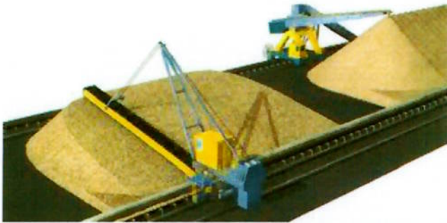
Figura 35 - Retomador de Ponte com raspador usado em cimenteiras.
