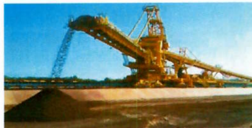
Figura 11 - Maior Stacker de minério de ferro localizado no Porto de Itaqui, MA.
